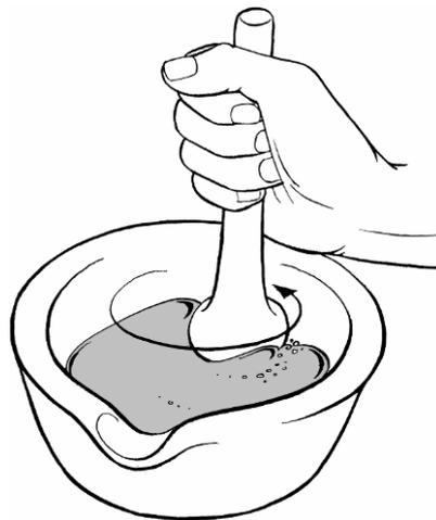
Anche la sabbia minerale polverizzata molto finemente è ancora troppo grossolana come pigmento per la pittura. Prima o dopo si arriva ad un punto in cui non succede più nulla. Occorre perciò separare le particelle più sottili dal materiale frammentato.
